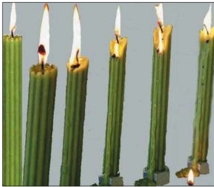
Abb. 18: Bildung eines zweiten Dochtes durch abfallenden Butzen
